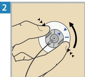
一面按住植入部位连接器的两侧，一面逆时针转动该连接器，直到两个箭头对准为止。
