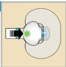
将发送器连接到探头。
