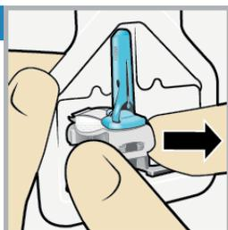
**2b** 折叠胶布粘合片。确保将探头胶布粘合片折叠在探头连接器和卡扣下方。
