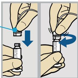
将管路连接器轻轻按到储药器上。顺时针转动连接器，直到其锁定到位为止。
