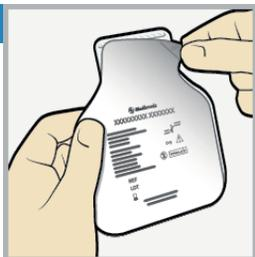
**2a** 捏住探头塑料底座。通过仅捏住底座,从包装中取出探头和与之相连的底座。将探头和底座放在干净平坦的表面(如桌面)上。
