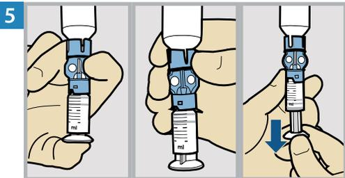
大拇指仍按在柱塞上，然后翻转，使药瓶处于上方。松开大拇指，向下拉柱塞，以使储药器充注胰岛素。
