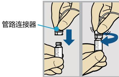
将管路连接器轻轻按到储药器上。顺时针转动连接器，直到其锁定到位为止。
